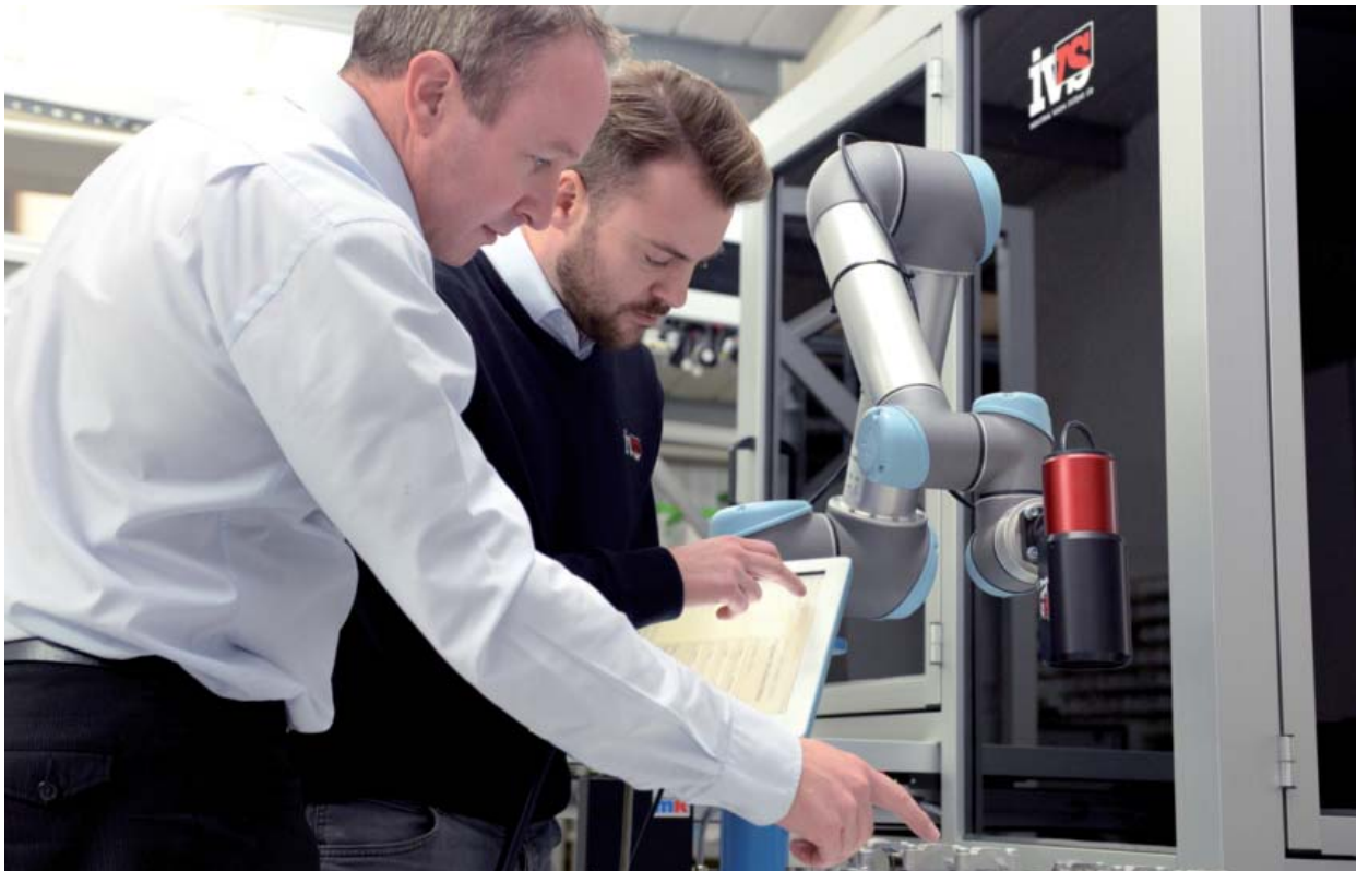
Bild 1 | Ein kollaborativer Tischroboter ermöglicht ohne aufwändige Sicherheitstechnik die automatisierte visuelle Porigkeitsprüfung von Zylinderköpfen in Verbindung mit einer Wirbelstromprüfung.
